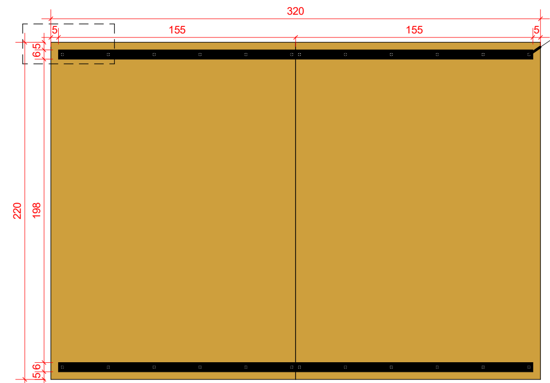
DET - PAREDE ESCALADA VISTA POSTERIOR (chapa maior)
