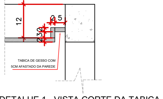
DETALHE 1 - VISTA CORTE DA TABICA SEM ESCALA
